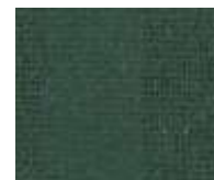
松 matsu 透光率 8% Mansel value(マンセル値) 紫外線カット率 93% (H)8.28YR(V)7.11(C)2.84
